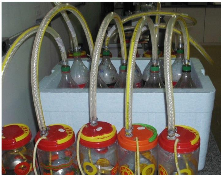
Figura 1 – Ensaio da digestão anaeróbia dos resíduos avícola e lácteo.
