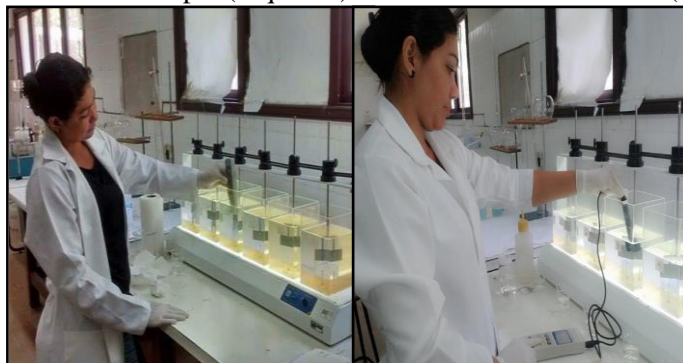
Figura 4 – Leitura do pH (esquerda) e leitura da condutividade (direita).
