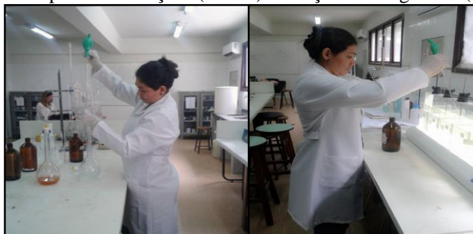
Figura 3 – Preparo das soluções (direita) e Adição do coagulante (esquerda)
