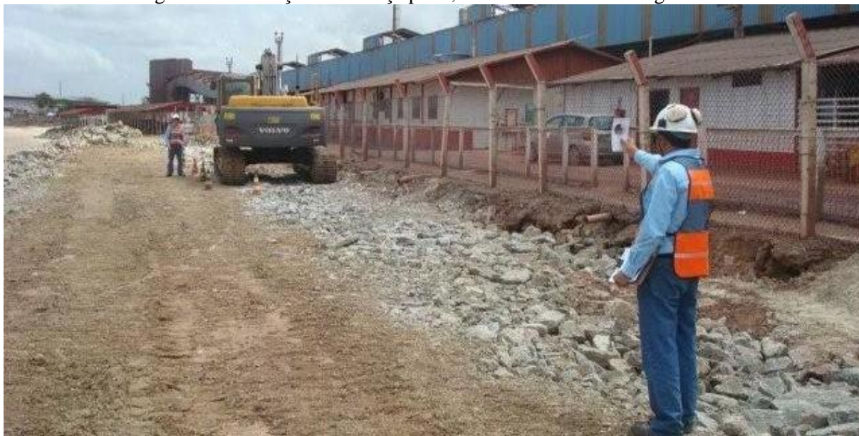
Figura 09 – Medição da fumaça preta, utilizando a Escala Ringelmann.
