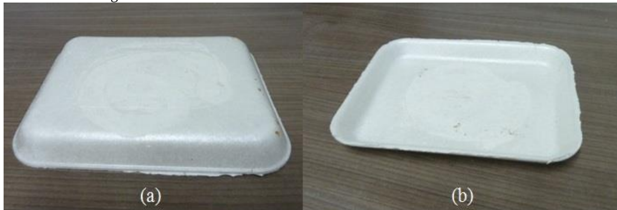
Figura 3 - Embalagem à base de amido de mandioca: (a) Vista externa da embalagem; (b) Vista interna da embalagem.
