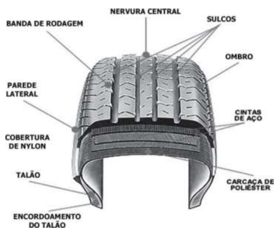
Figura 1: Estrutura de um pneu de passeio.
