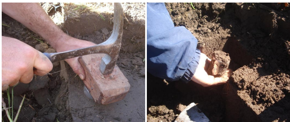
Figura 4. Coleta de amostras indeformadas de solo nas camadas de 0,00-0,05m, 0,05-0,10m e 0,10-0,20m com o auxílio de anéis volumétricos.
