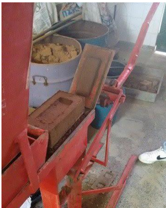
Figura 8: Moldagem do tijolo com 10% de lodo
