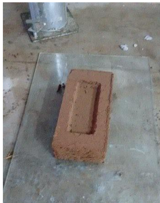
Figura 9: Tijolo com 15% de lodo
