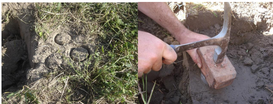
Figura 2. Coleta de amostras indeformadas de solo nas camadas de 0,00-0,05m, 0,05-0,10m e 0,10-0,20m com o auxílio de anéis volumétricos.
