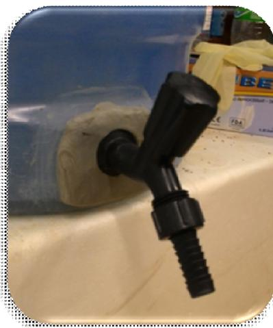
Após a realização dos cortes e furos, e inserida a torneira, verificou-se a estabilidade de encaixe entre as bombonas, na qual apresentaram boa estabilidade. Na Figura 4 é apresentada uma imagem da composteira em sua fase final de elaboração.
