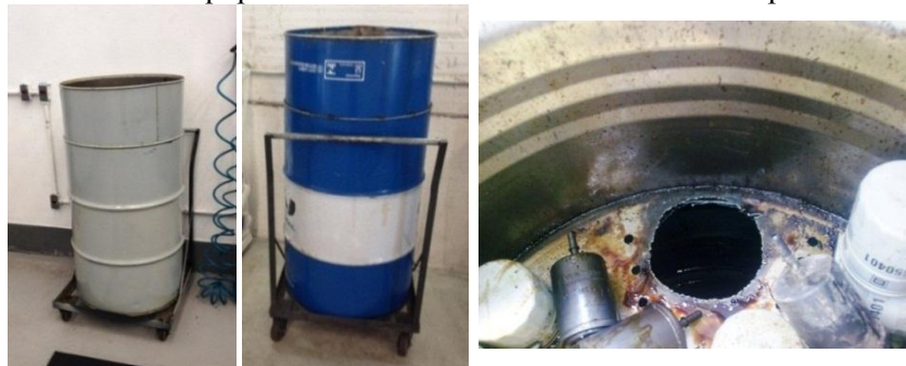
Figura 1 – Oficina ‘A’: Equipamentos de coleta e armazenamento temporário de óleo usado
