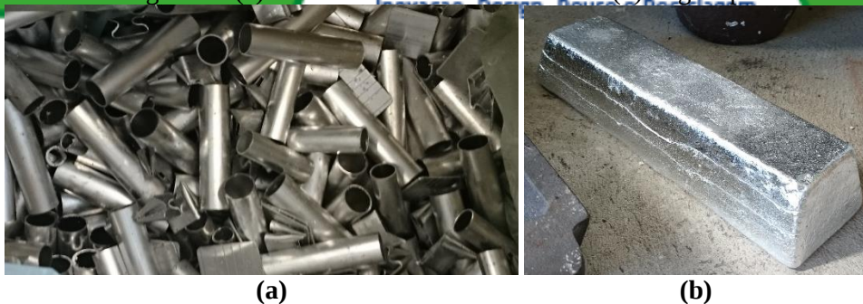
Figura 3 - (a) alumínio oriundo da indústria, e (b) lingote produzido.
