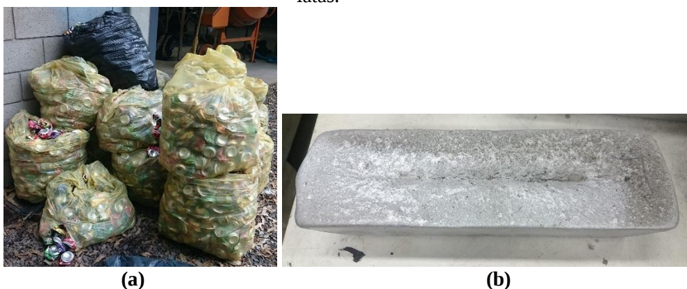
Figura 4 - (a) volume de latas amassadas e (b) lingote produzido através da fundição das latas.
