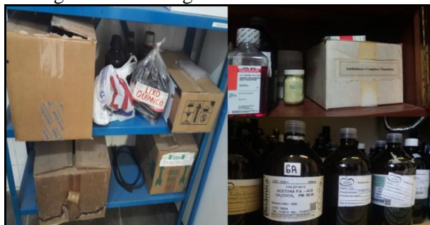
Figura 3 – Rotulagem indevida dos resíduos
