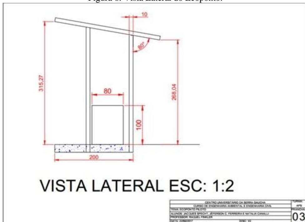
Figura 6: Vista Lateral do Ecoponto.
