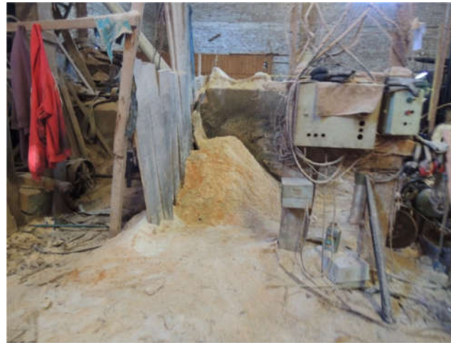
Figura 2 – Exemplo de armazenamento inadequado, com resíduos de serragem espalhados no piso da serraria C.
