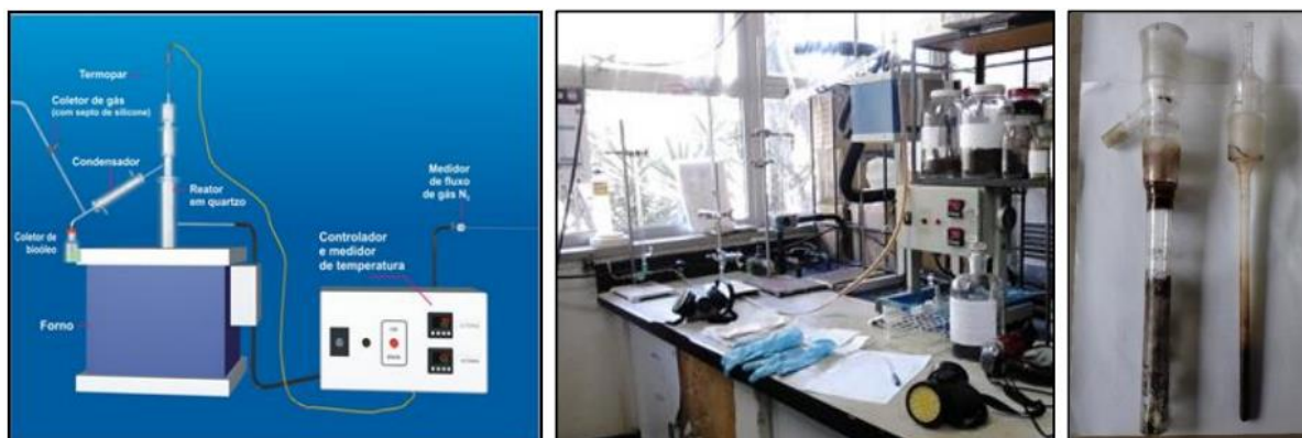
Figura 1 – Esquema de funcionamento e fotos do forno e do reator de pirólise.
