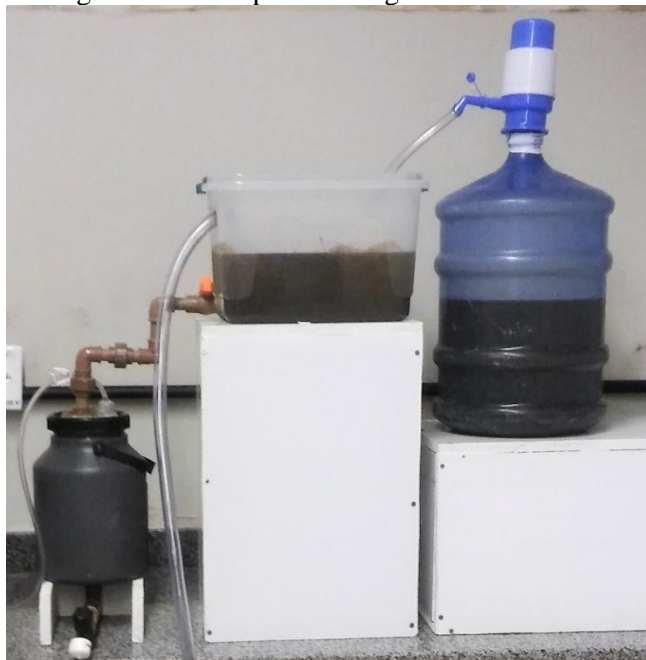
Figura 5. Protótipo de biodigestor em batelada
