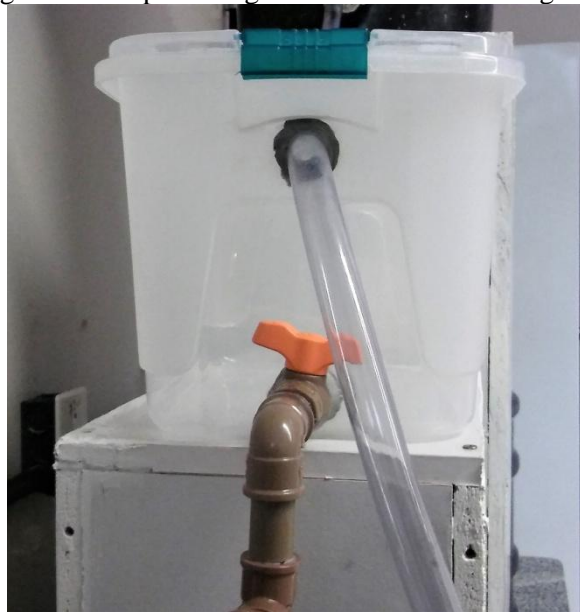
Figura 3. Recipiente regulador de nível do biodigestor.
