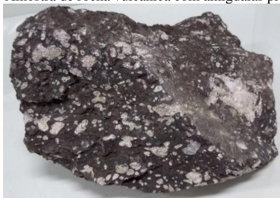
Figura 1 - Amostra de rocha vulcânica com amígdalas preenchidas com zeólitas.
