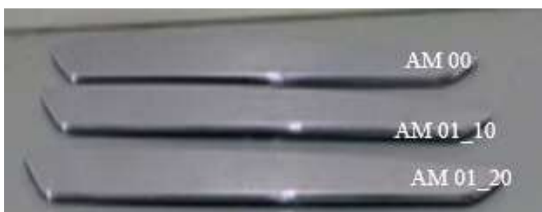
Figura 4 – Peças de ABS cromadas, ABS virgem (AM 00), e peças cromadas após a decapagem (AM 01_10 e AM 01_20).
