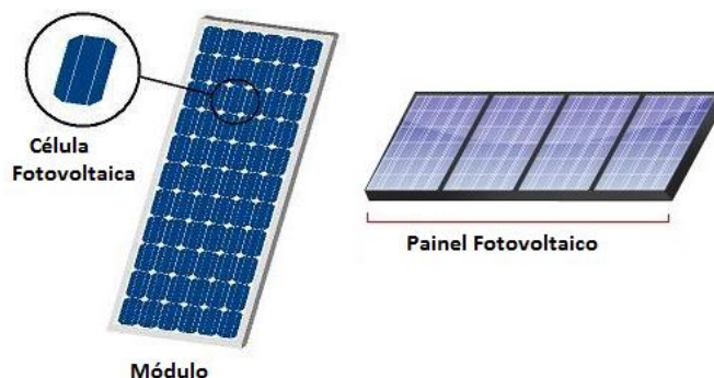
Figura 2. Célula, módulo e painel fotovoltaico. Fonte: Adaptado de PAINEIS FOTOVOLTAICOS (2018) e ELECTRÓNICA (2018).
