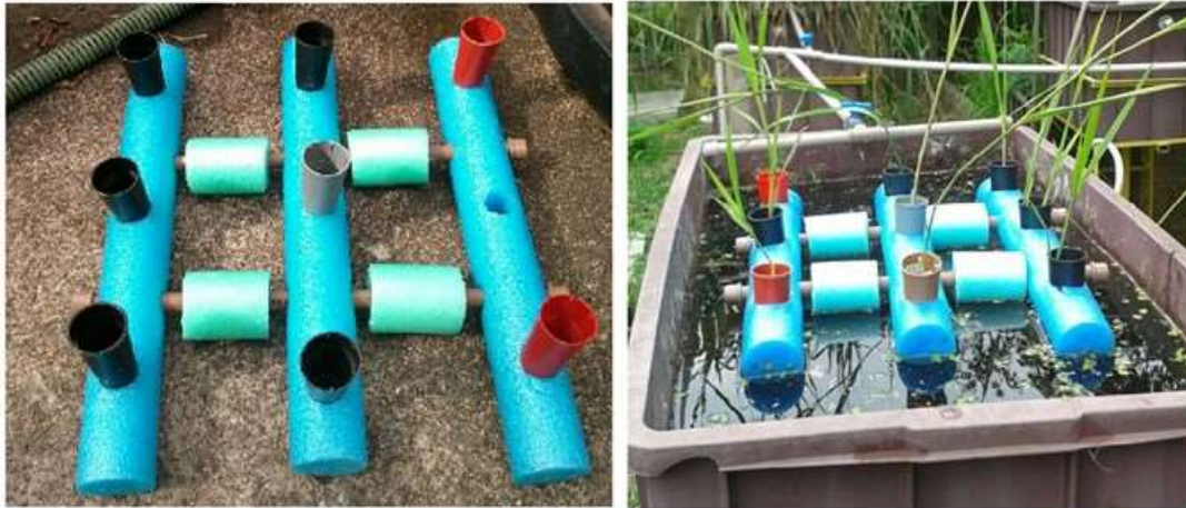
Figura 5. Registros da fabricação do sistema suporte flutuante para o W1 e o mesmo após a adição das macrófitas.
