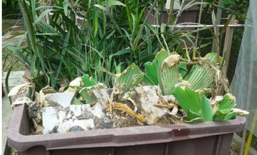
Figura 3. Sistema flutuante de EVA (W1) após sofrer diversas deformações.
