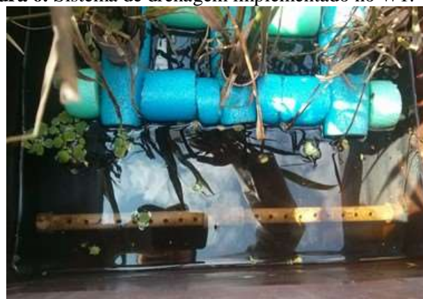
Figura 6. Sistema de drenagem implementado no W1.
