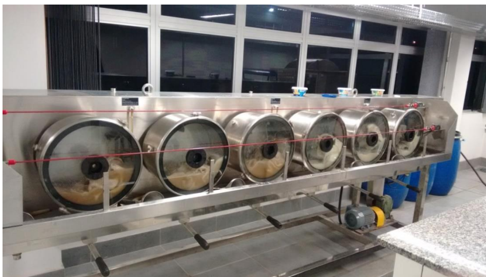
Figura 1: Curtimento de peles no conjunto de fulões piloto.
