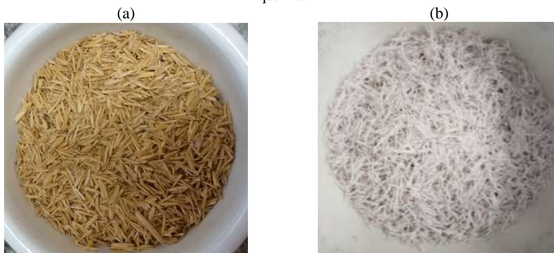
Figura 1 – Fotografias de (a) casca de arroz como recebida e (b) cinza da casca de arroz após a queima.
