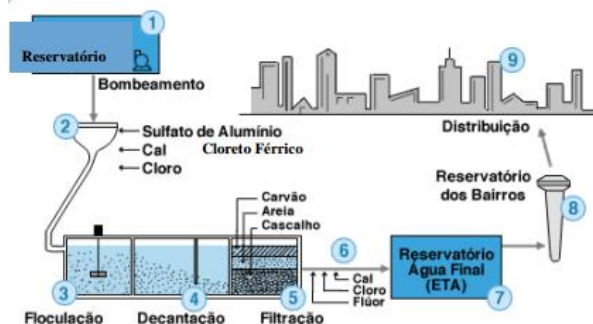
Figura 1 – Esquema de sistema de abastecimento de água convencional.
